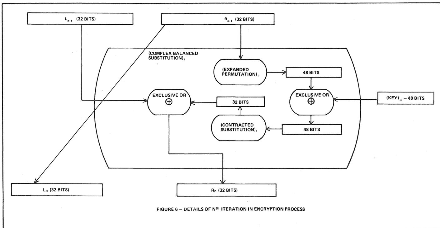
FIGURE 6 — DETAILS OF  $N^{th}$  ITERATION IN ENCRYPTION PROCESS
